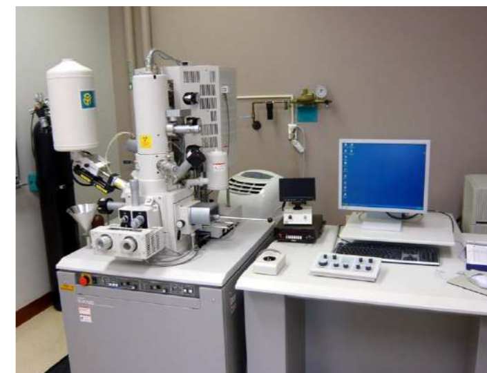
[23] Na slici je moderan elektronski mikroskop sa vakuum pumpom koja stvara vakuum za prolazak elektrona, akceleratorom za ubrzavanje elektrona, postoljem za bakarnu mrežicu, ležištem za film na kojem elektroni prave sliku i pratećom softverskom podrškom za prenos slike na ekran. Isečeni preseki uzorka kod elektronske mikroskopije ne montiraju se na predmetno staklo već na bakarnu mrežicu koja se zajedno sa uzorkom "bombarduje" snopom elektrona
